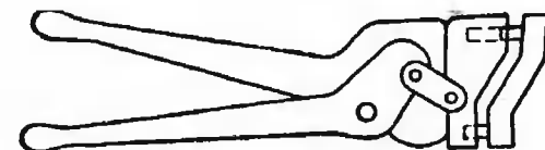
Рис. 88. Клещи для изгибания роторных стержней.
