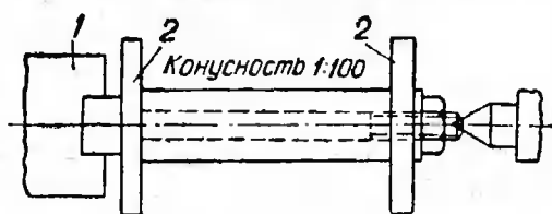
Рис. 145. Установка оправки на станок:
